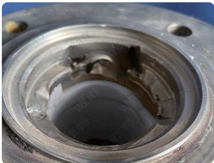
某有色冶金排料阀阀体金属部分 21 天冲蚀情况
