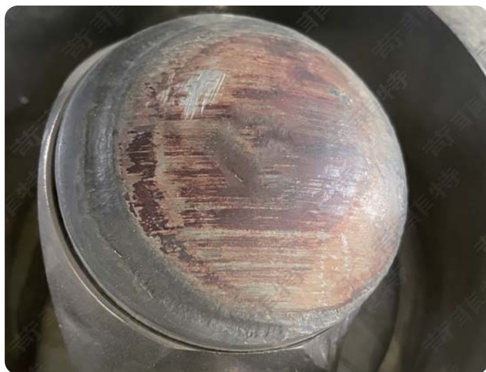
陶瓷阀芯连续使用 1 年，未发现明显冲蚀
