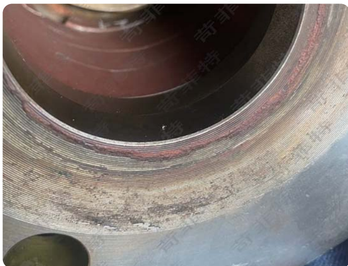
陶瓷衬里阀体连续使用 1 年，未发现明显冲蚀
