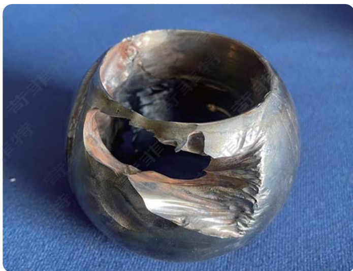
某有色冶金金属材质阀芯 14 天冲蚀情况
