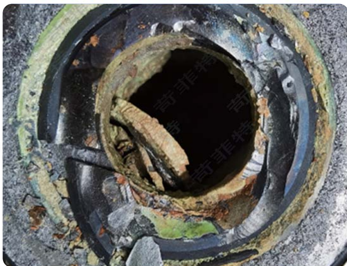
普通陶瓷阀门使用 21 天后陶瓷碎裂
